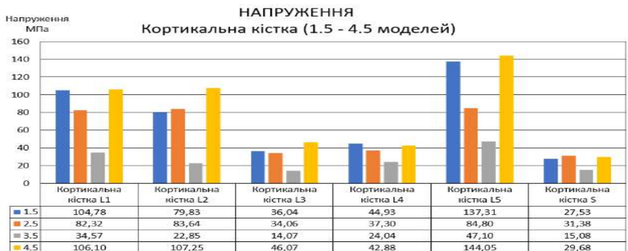
Рис. 4.22. Максимальні еквівалентні напруження — кортикальна кістка (1.5, 2.5, 3.5, 4.5 розрахункові схеми)
