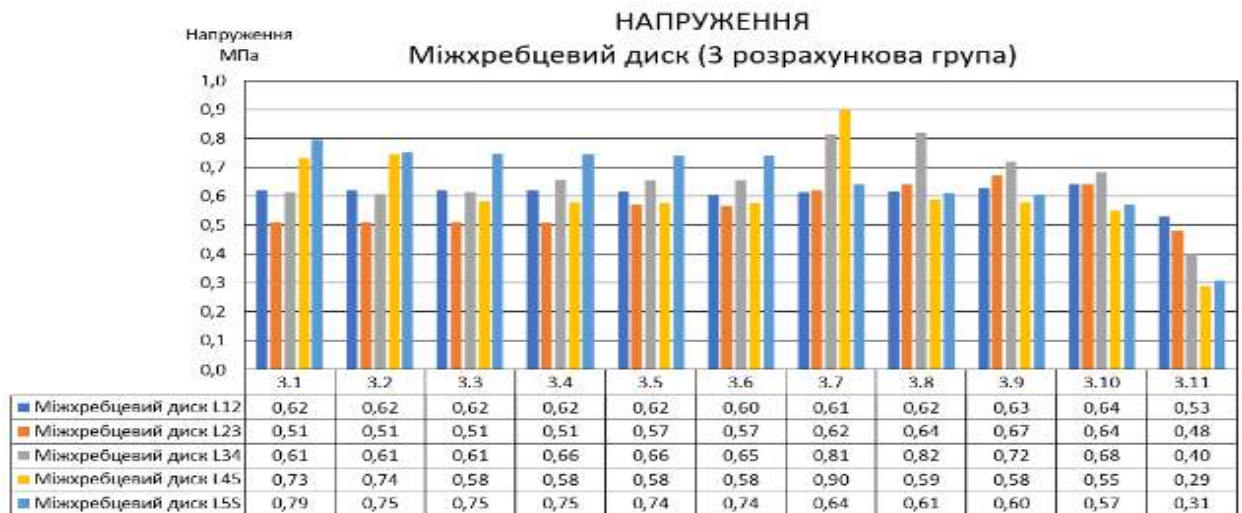
Рис. 4.12. Максимальні еквівалентні напруження — 3-тя розрахункова група (міжхребцеві диски)
