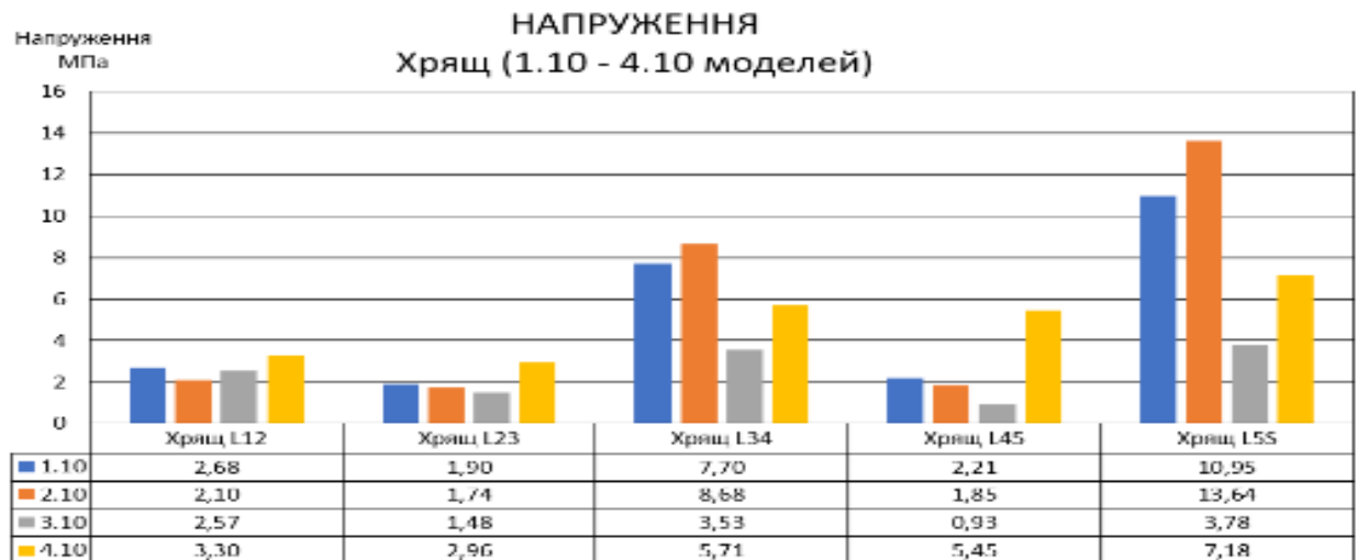
Рис. 4.49. Максимальні еквівалентні напруження — хрящ (1.10, 2.10, 3.10, 4.10 розрахункові схеми)
