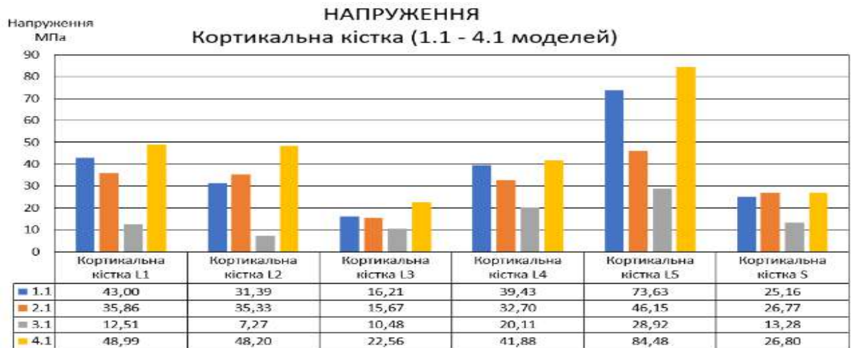
Рис. 4.18. Максимальні еквівалентні напруження — кортикальна кістка (1.1, 2.1, 3.1, 4.1 розрахункові схеми)
