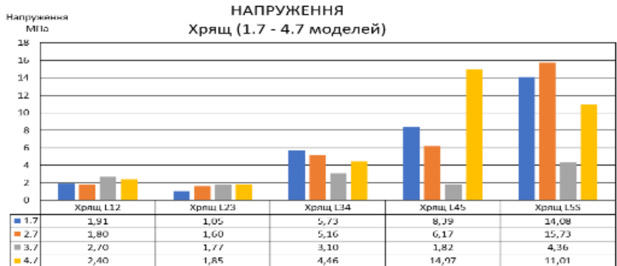
Рис. 4.46. Максимальні еквівалентні напруження — хрящ (1.7, 2.7, 3.7, 4.7 розрахункові схеми)
