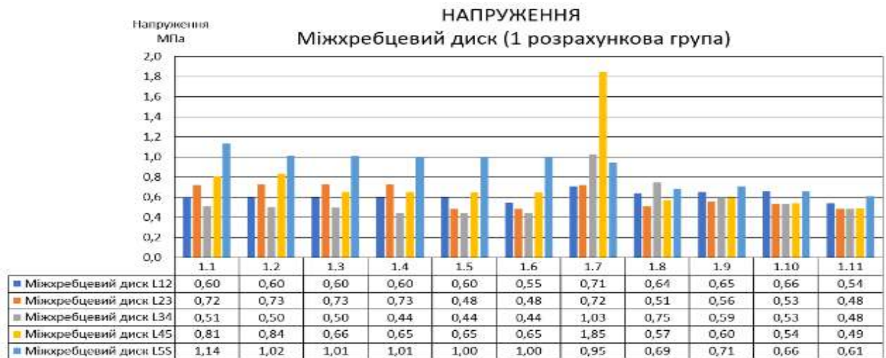
Рис. 4.10. Максимальні еквівалентні напруження — 1-ша розрахункова група (міжхребцеві диски)
