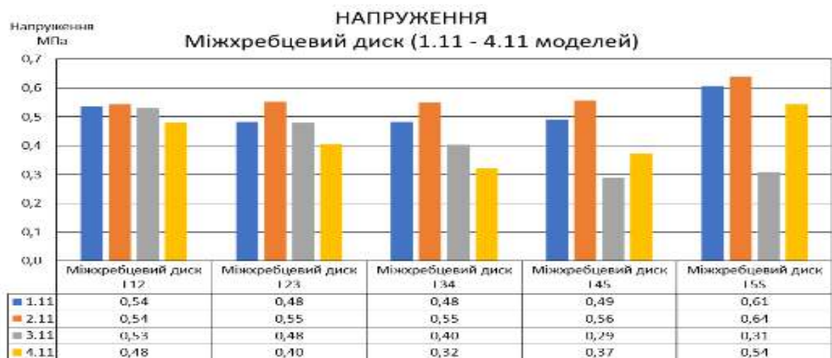
Рис. 4.39. Максимальні еквівалентні напруження — міжхребцевий диск (1.11, 2.11, 3.11, 4.11 розрахункові схеми)
