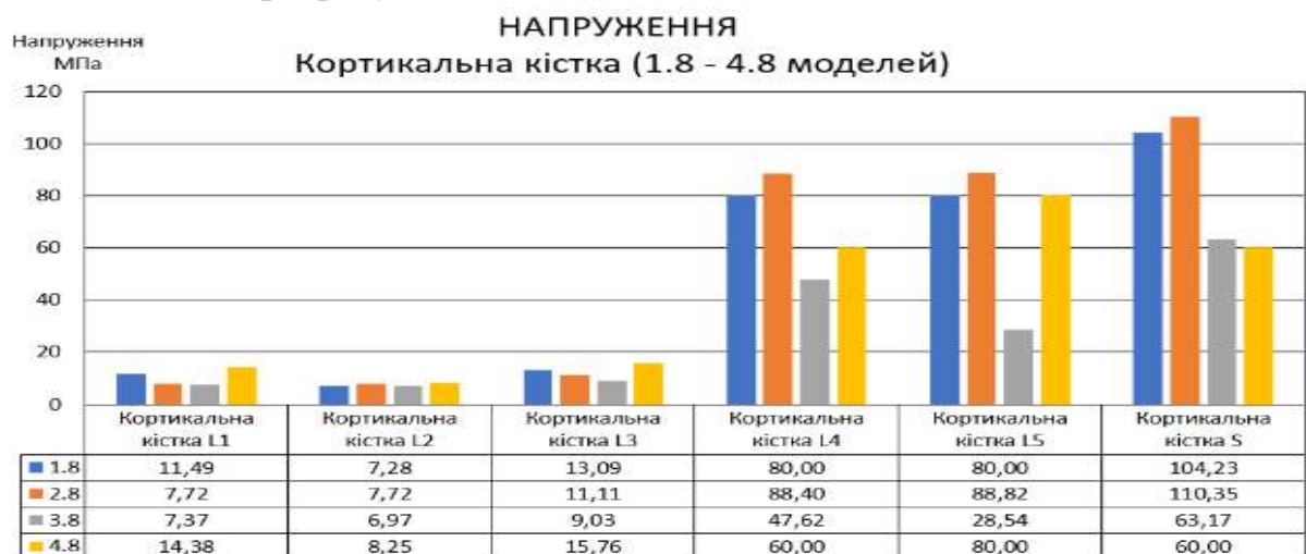
Рис. 4.25. Максимальні еквівалентні напруження — кортикальна кістка (1.8, 2.8, 3.8, 4.8 розрахункові схеми)
