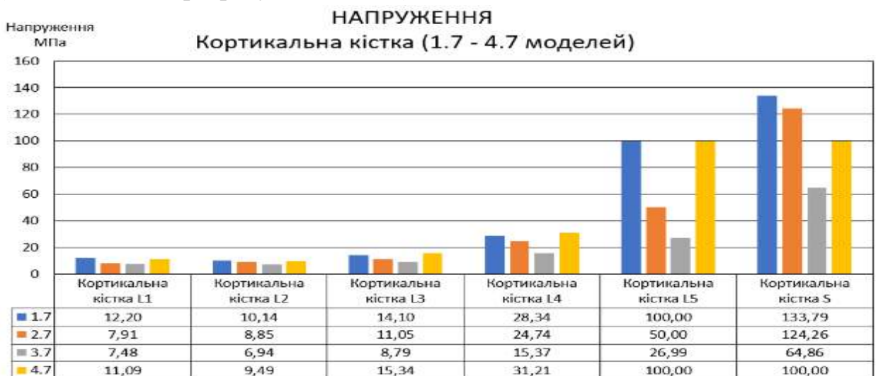
Рис. 4.24. Максимальні еквівалентні напруження — кортикальна кістка (1.7, 2.7, 3.7, 4.7 розрахункові схеми)
