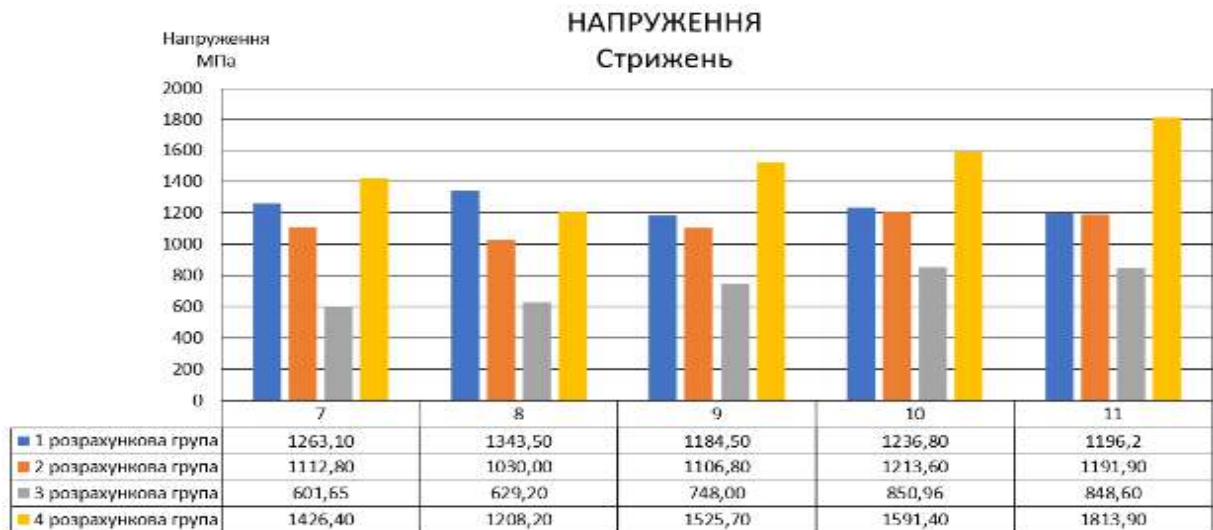
Рис. 4.51. Максимальні еквівалентні напруження — стрижень
