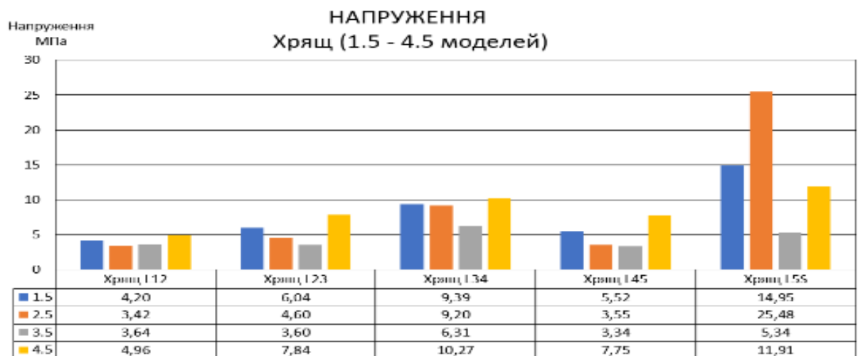
Рис. 4.44. Максимальні еквівалентні напруження — хрящ (1.5, 2.5, 3.5, 4.5 розрахункові схеми)
