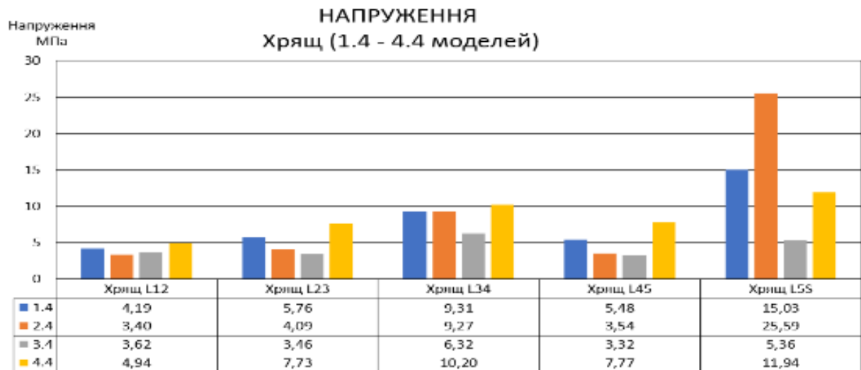
Рис. 4.43. Максимальні еквівалентні напруження — хрящ (1.4, 2.4, 3.4, 4.4 розрахункові схеми)
