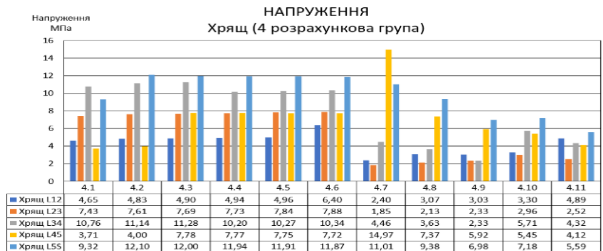
Рис. 4.17. Максимальні еквівалентні напруження — 4-та розрахункова група (хрящі дуговідросткового суглобу)
