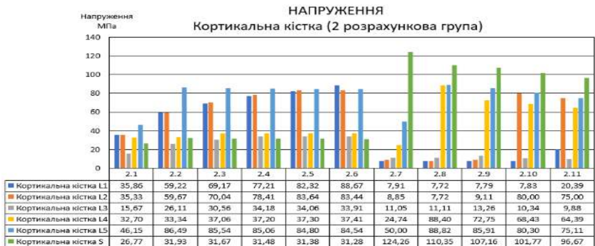
Рис. 4.7. Максимальні еквівалентні напруження — 2-га розрахункова група (кортикальні кістки)
