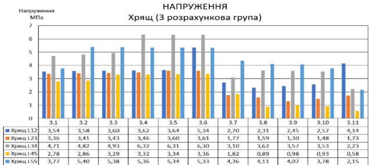
Рис. 4.16. Максимальні еквівалентні напруження — 3-тя розрахункова група (хрящі дуговідросткового суглобу)
