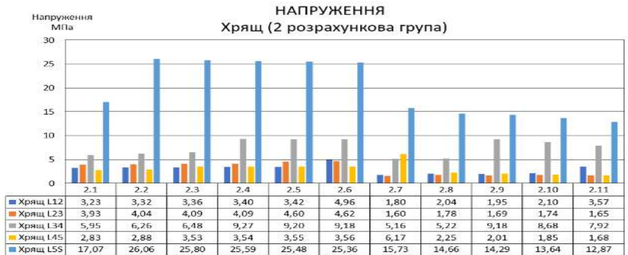
Рис. 4.15. Максимальні еквівалентні напруження — 2-га розрахункова група (хрящі дуговідросткового суглобу)
