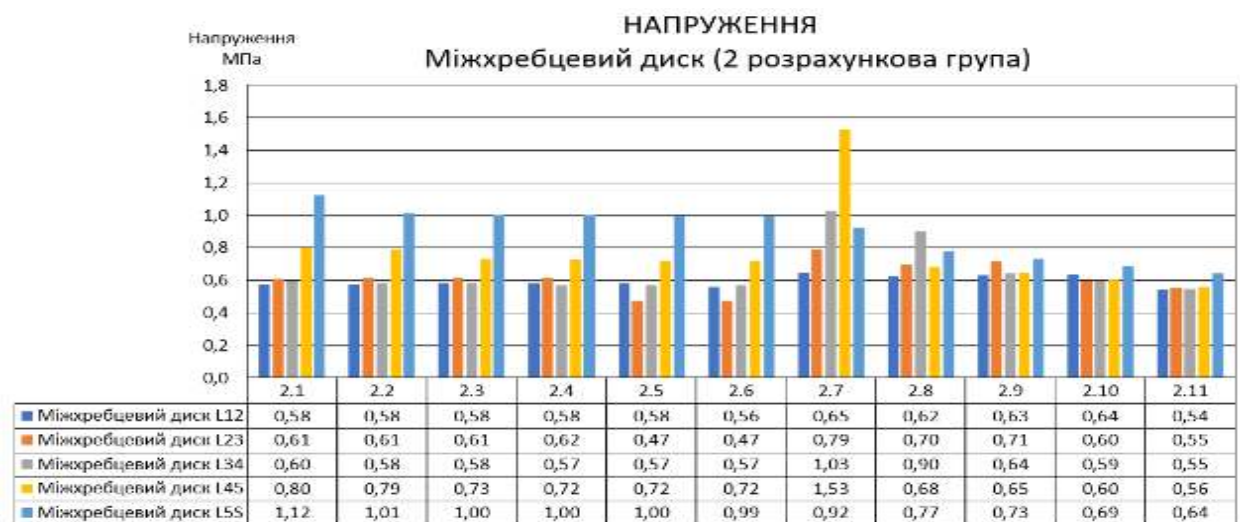
Рис. 4.11. Максимальні еквівалентні напруження — 2-га розрахункова група (міжхребцеві диски)
