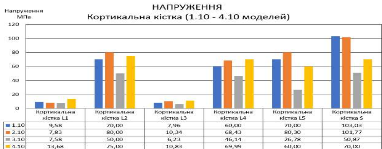
Рис. 4.27. Максимальні еквівалентні напруження — кортикальна кістка (1.10, 2.10, 3.10, 4.10 розрахункові схеми)
