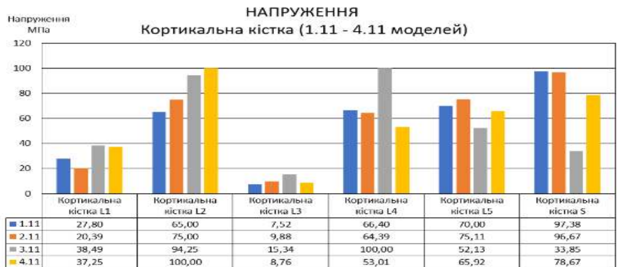
Рис. 4.28. Максимальні еквівалентні напруження — кортикальна кістка (1.11, 2.11, 3.11, 4.11 розрахункові схеми)
