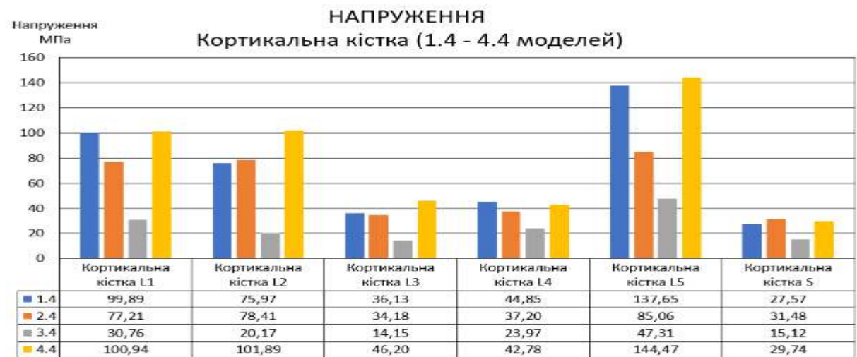
Рис. 4.21. Максимальні еквівалентні напруження — кортикальна кістка (1.4, 2.4, 3.4, 4.4 розрахункові схеми)
