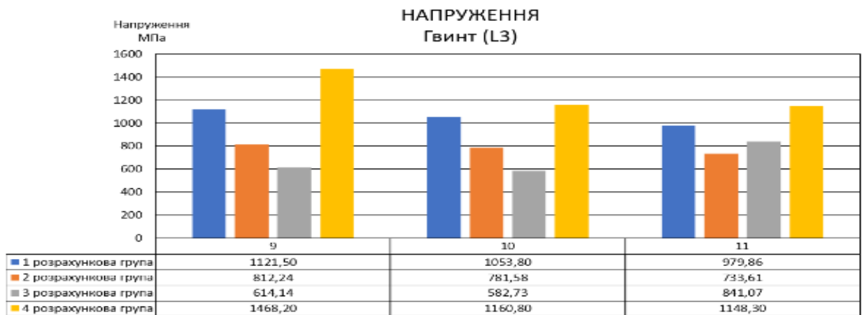
Рис. 4.55. Максимальні еквівалентні напруження — гвинт ( L_{III} )
