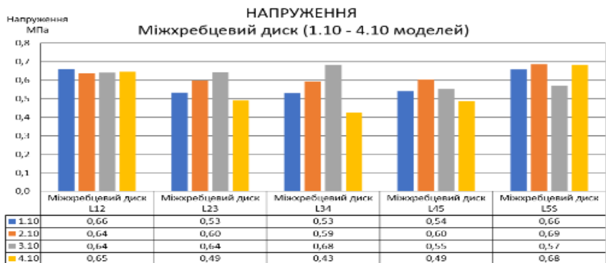
Рис. 4.38. Максимальні еквівалентні напруження — міжхребцевий диск (1.10, 2.10, 3.10, 4.10 розрахункові схеми)
