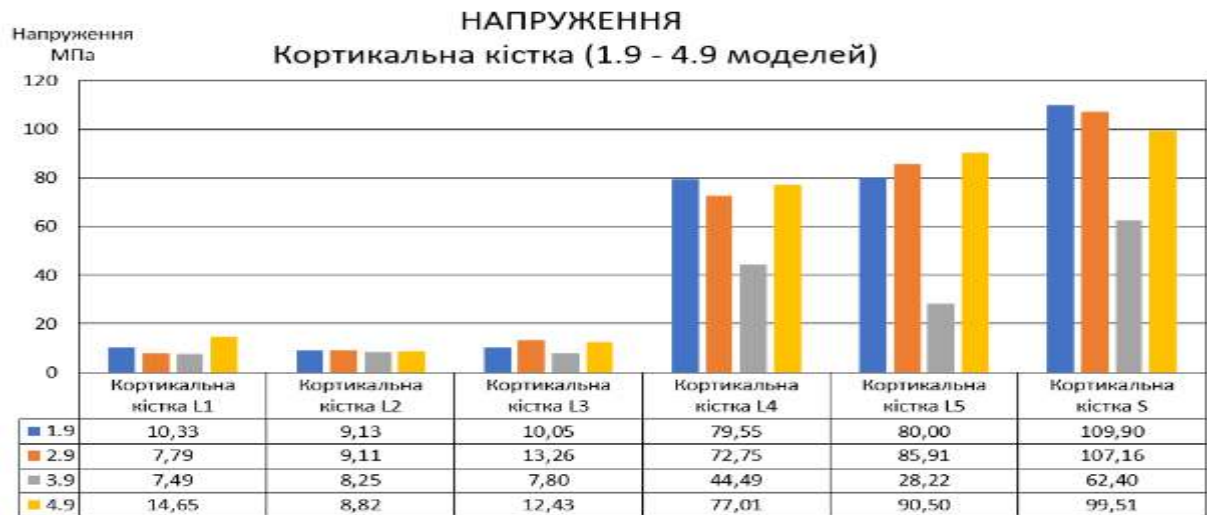
Рис. 4.26. Максимальні еквівалентні напруження — кортикальна кістка (1.9, 2.9, 3.9, 4.9 розрахункові схеми)
