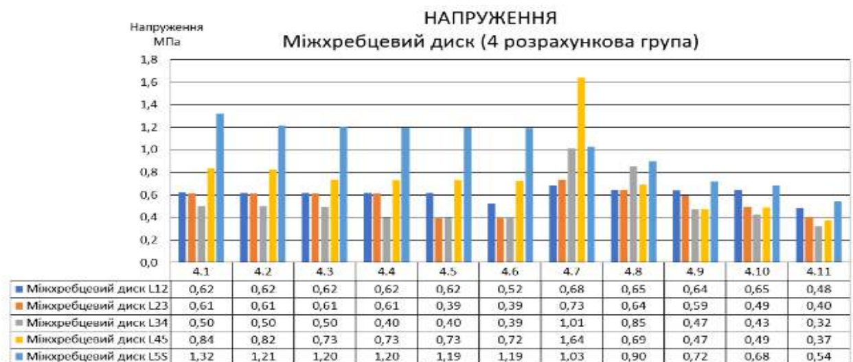
Рис. 4.13. Максимальні еквівалентні напруження — 4-та розрахункова група (міжхребцеві диски)
