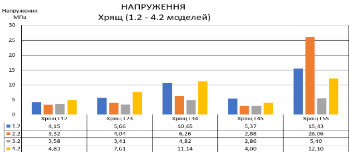
Рис. 4.41. Максимальні еквівалентні напруження — хрящ (1.2, 2.2, 3.2, 4.2 розрахункові схеми)
