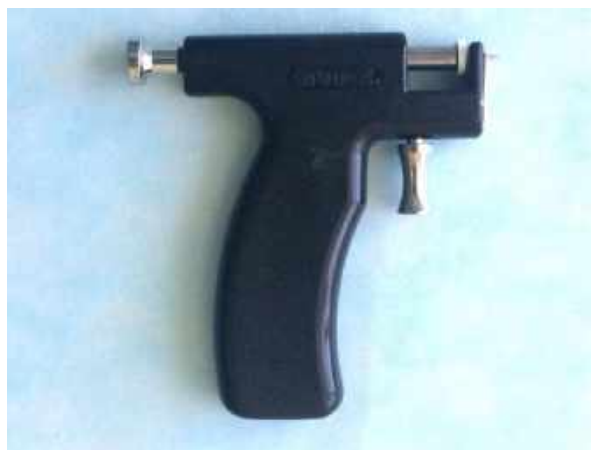
Рис. 4. Пристрій для виконання стандартизованих внутрішньосуглобових ушкоджень у експериментальних тварин.
