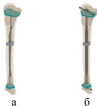
Рис. 1. Моделі великогомілкової кістки з інтрамедулярними фіксаторами різних типів: титанові еластичні стрижні (а); інтрамедулярний телескопічний фіксатор (б).
