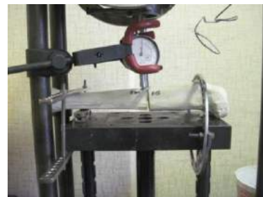
Рис. 2. Схема експерименту навантаження на згинання. Д – динамометр, М – мікрометр, F – сила згинання, \Delta l – переміщення моделі (а); фото пристрою для біомеханічних досліджень під час проведення експерименту (б).
