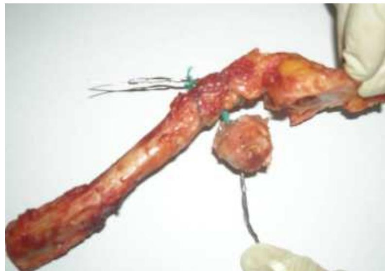
Рис. 2.7. Анатомический блок «ключица-клювовидный отросток» после фиксации системой «АКК-Такелаж» с проволочными серкляжами для фиксации в зажимах разрывной машины.
