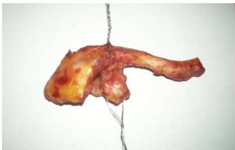
Рис. 2.5. Анатомический блок «ключица-клювовидный отросток» с проволочными серкляжами для фиксации в зажимах разрывной машины.
