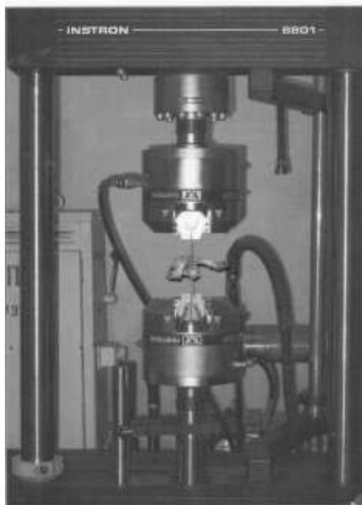
Рис. 2.6. Положение анатомического препарата в зажимах испытательной машины для измерения силы на разрыв.
